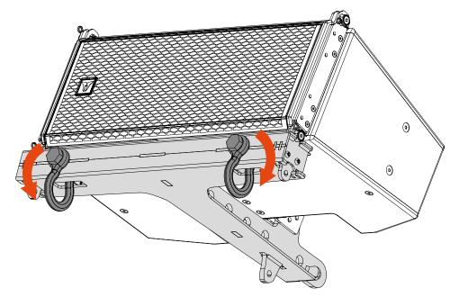
TURN THE SHAKLES UPSIDE DOWN WHEN USING THE FLYBAR ON BOTTOM CONFIGURATION
